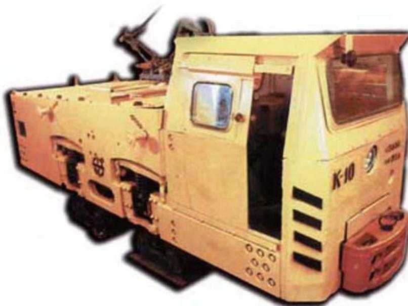
Рисунок 2 Электровоз марки 7К10 производства ОАО «Александровский машиностроительный завод»
