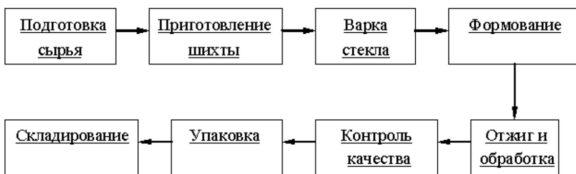
Рисунок 1. Типовая технологическая схема промышленного способа получения стекла
