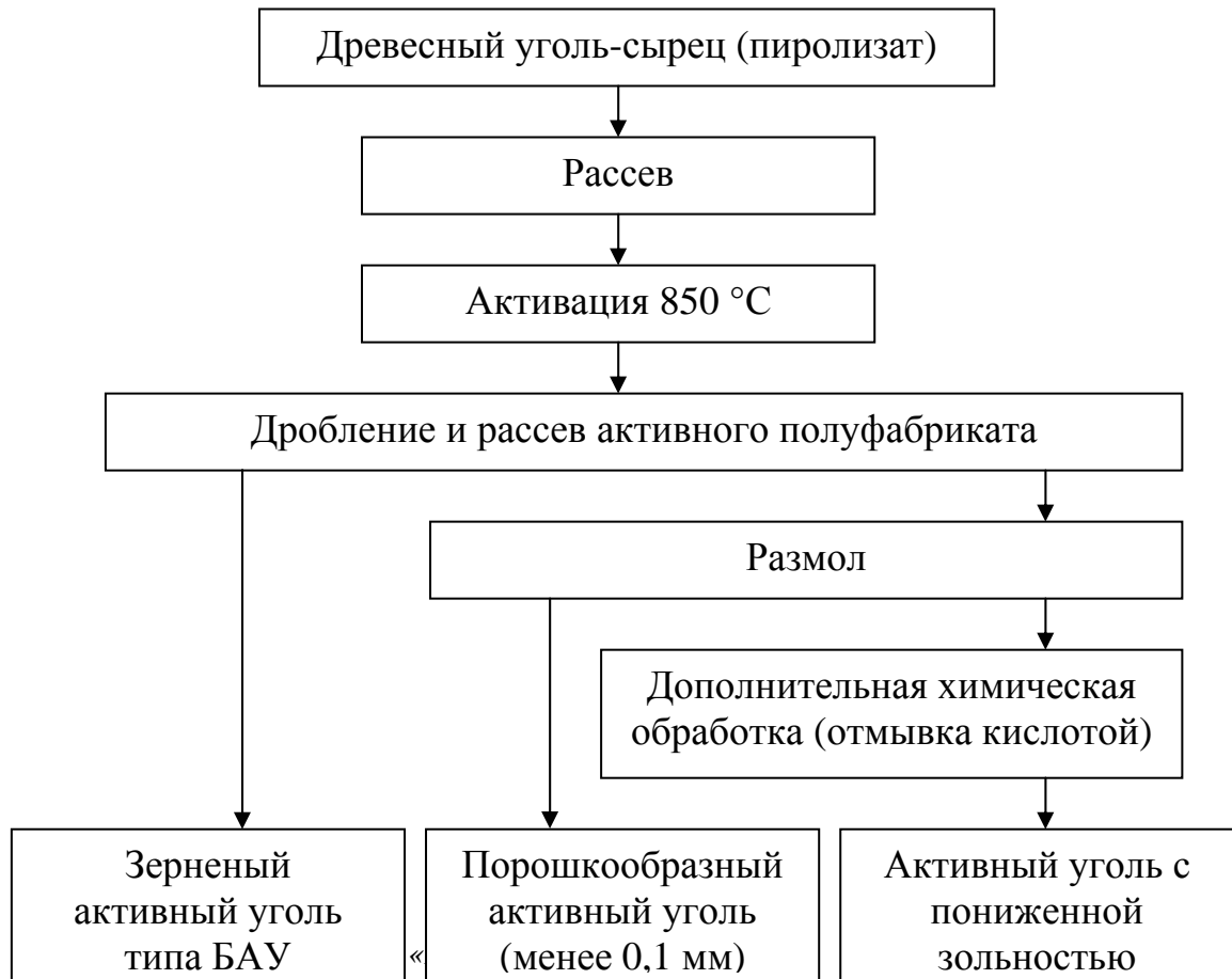
Рисунок 2. Технологический процесс изготовления активированных углей на основе древесного угля-сырца
