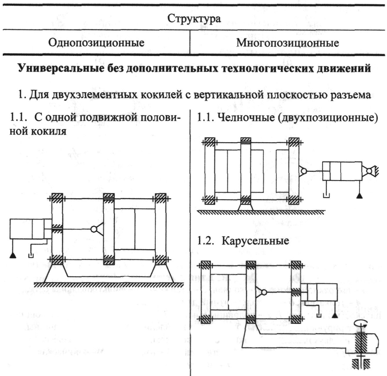
Рисунок 1: Классификация кокильных машин
